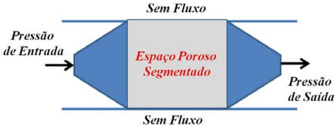
**Figura 9 - Ilustração esquemática das condições de contorno para a simulação de permeabilidade absoluta utilizada no software Avizo (adaptado de Islam *et al* 2018).**
