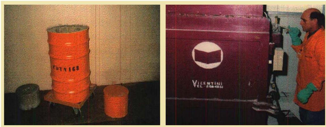
**Figura 2.2** – Embalagens de rejeitos para fontes exauridas (à esquerda) e operação de compactação de rejeitos sólidos (à direita)
