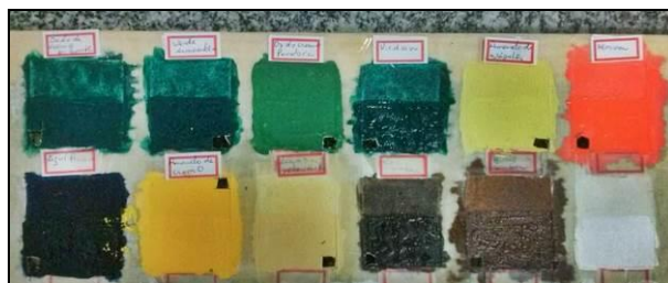
Figura 4.15. Retirada de amostras para análise no microscópio.
