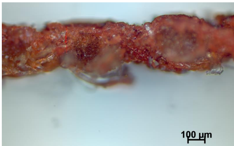
Figura 5.9. Seis camadas do pigmento vermelho ocre – Espessura aproximada de 156,19 μm.
