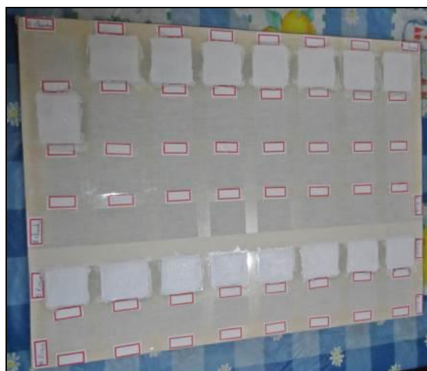
Figura 4.12. Camada de preparação com o pigmento branco de chumbo.
