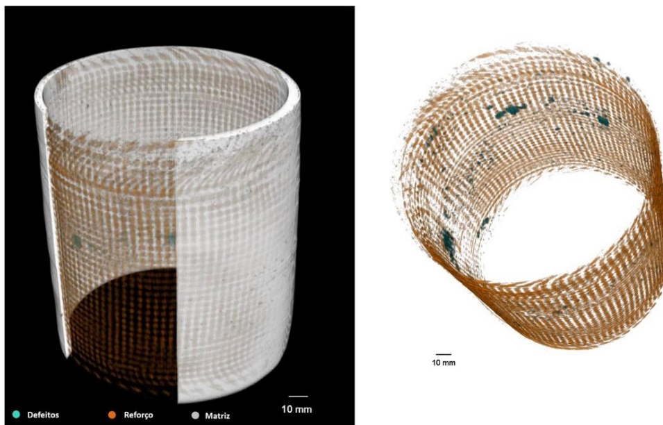
Figura 5.27: Região laminada da Junta 4 contendo as fases de matriz, reforço e defeitos.
