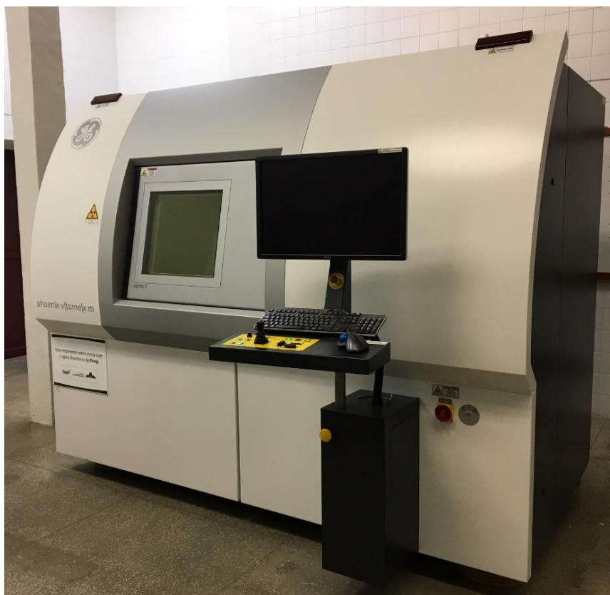
Figura 4.7: Sistema de microCT e nanoCT utilizado.
