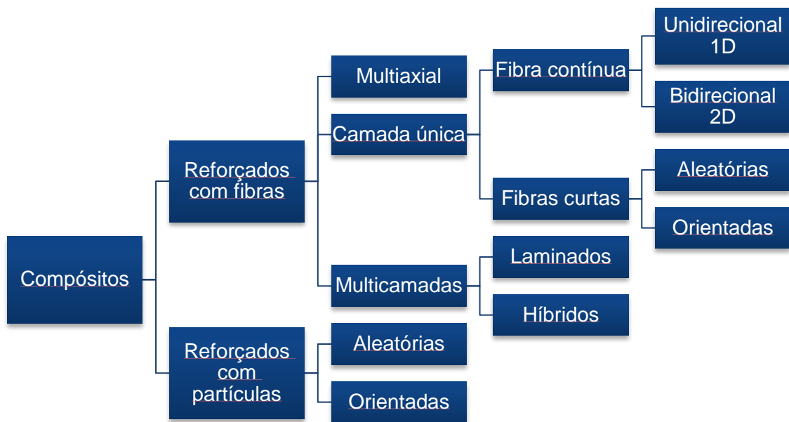
Figura 3.11: Proposta de classificação hierárquica de compósitos sintéticos e naturais (LEVY & PARDINI, 2016).
