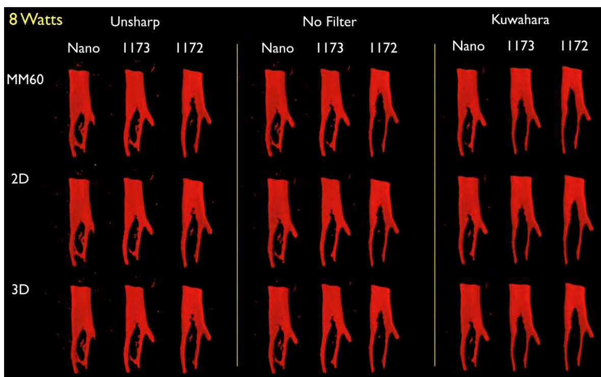
Figura 17. Fotografia 2D da renderização 3D dos 27 datasets finais, relativos ao aparelho 1172, 1173 e NanoTom, em 8 watts separados em colunas referentes aos filtros utilizados
