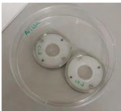
Figura 19 – Foto do porta amostra utilizado na TwinMic.
