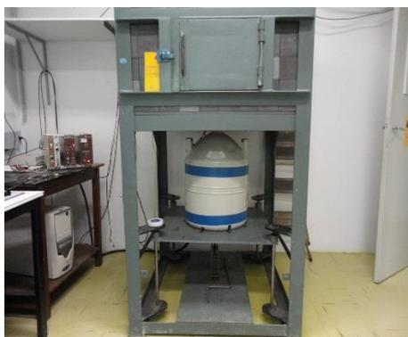
**Figura 5. 3: Detector de HPGe tipo planar**
