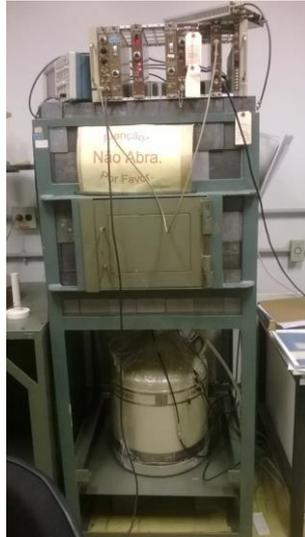
**Figura 5. 5: Detector de HPGe tipo coaxial**
