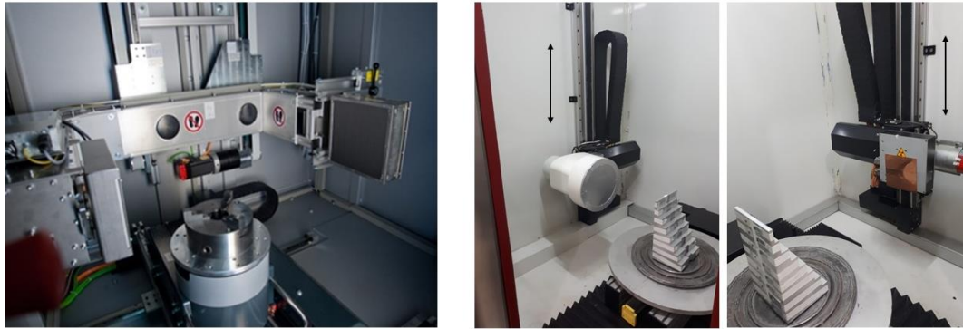
(a) Movimentação em Braço C da fonte e detector
