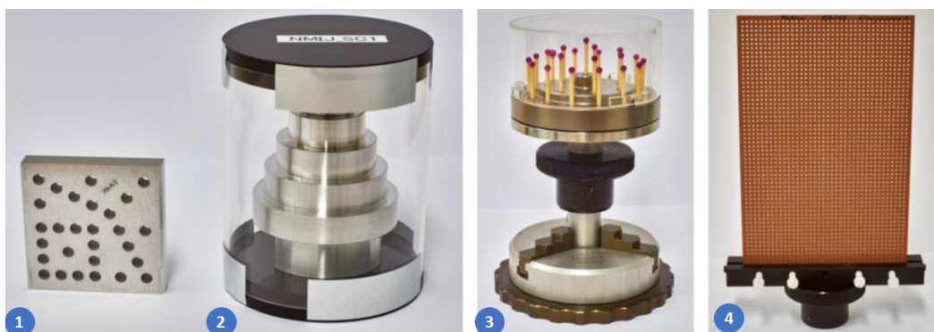
Figura 3.4: Dispositivos de testes ( phantom ) de referência para avaliação dos erros geométricos por imagem, segundo PTB, adaptado de [78]. 1- Placa de furo, 2 – Cilindro Escalonado, 3- Padrão Multi-Esferas, 4- Placa em fibra de vidro perfurada.
