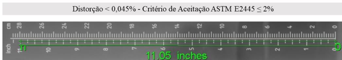
Figura 2.7: Medição da distorção geométrica de um IP, adaptado de [66]
