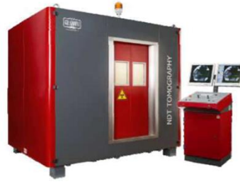
Fabricante: GILARDONI - Modelo: CST7 Parâmetros Radiológicos: 225 kV/7,0 mA
