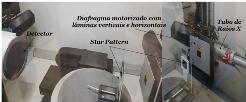
Figura 4.8: Arranjo experimental para avaliação do ponto focal com Star Pattern do equipamento de radioscopia industrial RA
