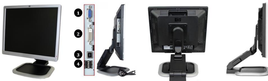
Figura 4.24: Monitor LA1951g. (1) Entrada VGA (2) Entrada DVI (3) Entrada USB Upstream (4) Saída USB Downstream
