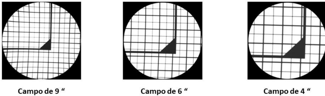
Figura 4.20: Comparação entre os FOV e distorção geométrica de um intensificador
