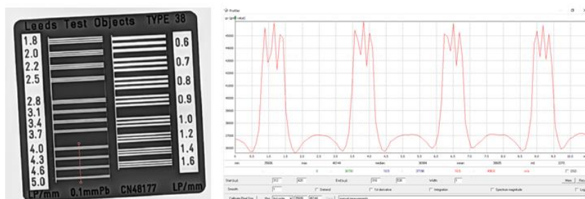
Figura 5.10: Imagem radioscópica do Bar Pattern e seu respectivo perfil de linha para o equipamento de radioscopia RB com ponto focal de 0,4 mm
