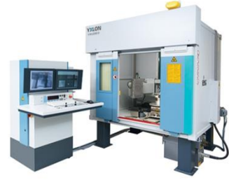
Fabricante: YXLON - Modelo: Y.MU2000D Parâmetros Radiológicos: 225 kV/7,0 mA
