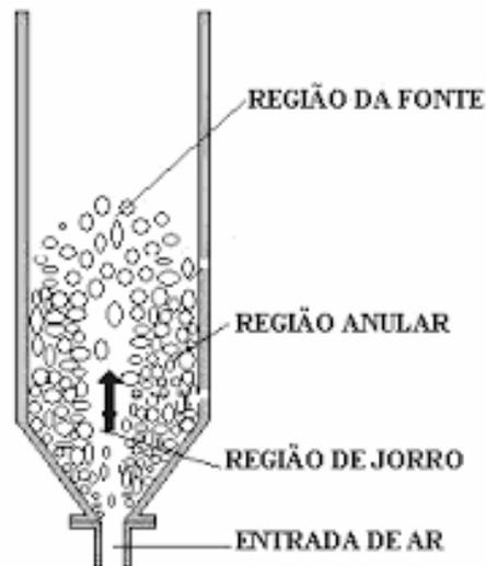
Figura 2.2: Desenho esquemático de um leito de jorro.
