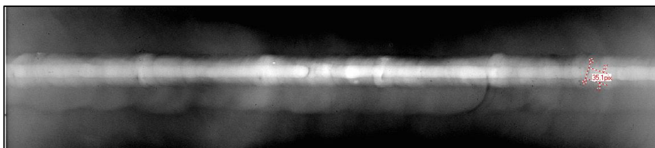
Figura 51: Posicionamento de descontinuidade nas imagens feitas com o DDA.
