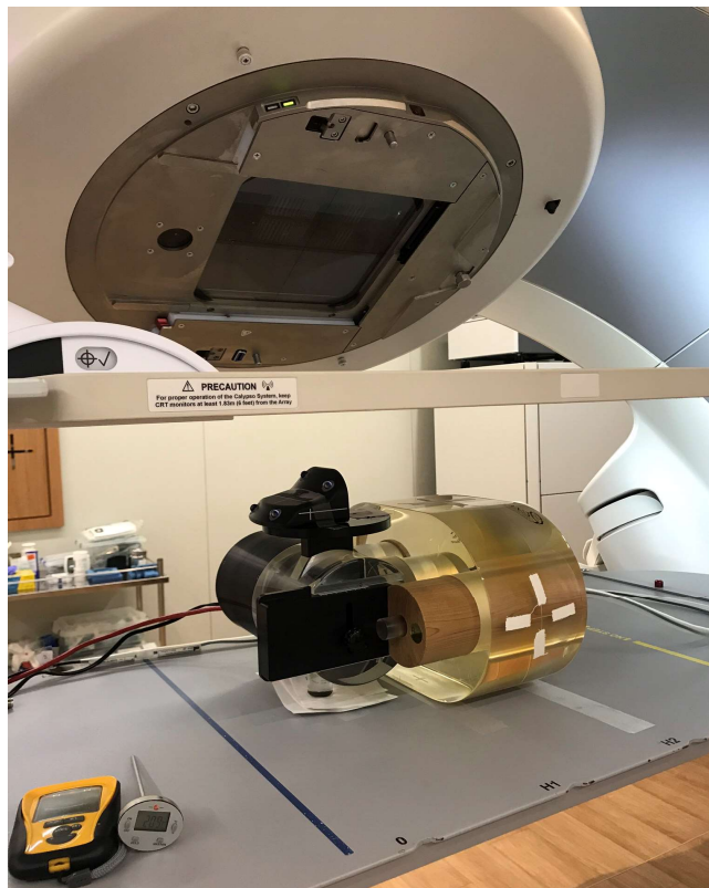
Figura 26. Posicionamento do objeto simulador Quasar para a medida de dose no teste ponta-a-ponta para seis diferentes curvas específicas de paciente.
