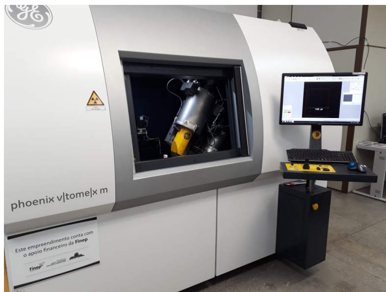
Figura 11 - Sistema de microCTPhoenix v|tome|x m da GE (General Electric).
