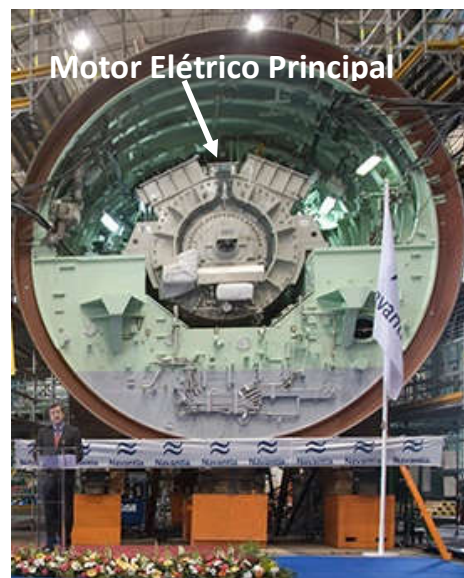
Figura 33: Motor elétrico principal de um submarino convencional construído pela empresa Navantia. Fonte: NAVAL TECHNOLOGY [43].
