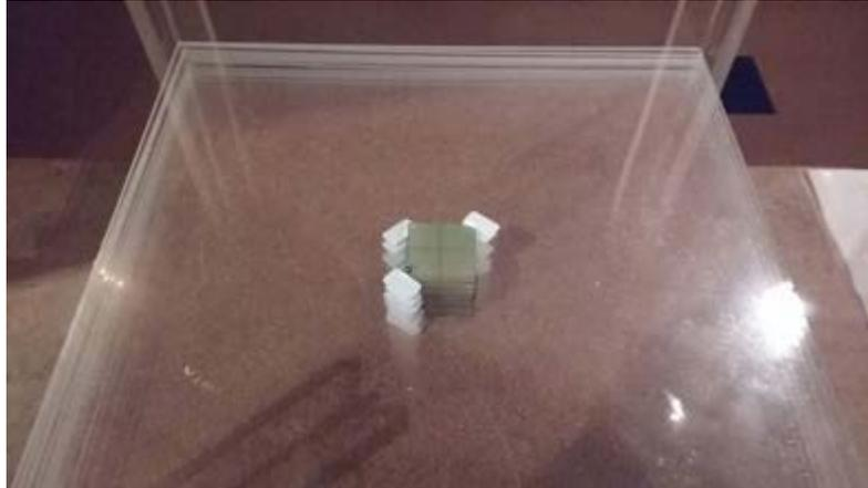
**Figura 3.6** - Empilhamento dos filmes radiocrômicos através do acrílico na camada 1. (Radioterapia/INCA)
