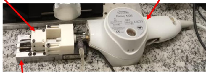
Figura 4.5.5: Foto do sistema de controle de deslocamento telescópico do miniprobe, o estágio linear e motor drive.
