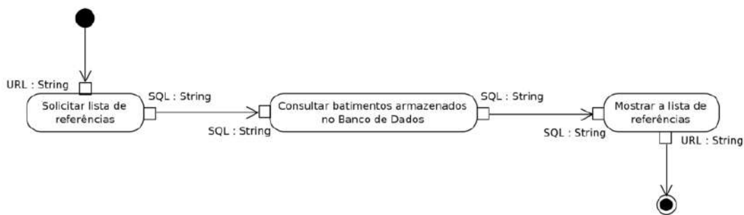
Figura 66 – Diagrama de Atividade para a listagem das referências para os batimentos no navegador.
