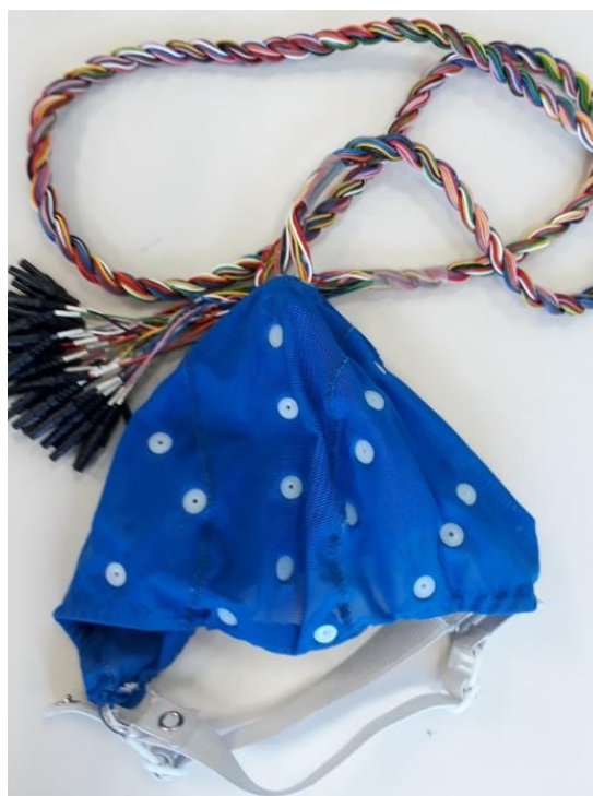
Figura 4.6 – Touca de eletrodos para aquisição do sinal de EEG.
