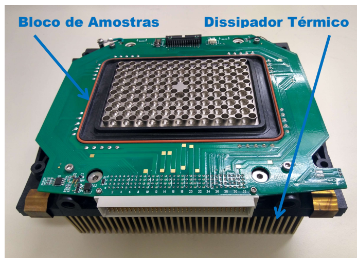
Figura 4: Foto de bloco termoelétrico de 96 poços destacando o bloco de amostras e o dissipador térmico.
