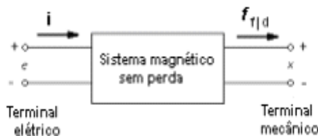
Figura III.5 - Modelo de conversão de energia eletromecânica (adaptado de UMANS (2013)). A conversão da energia elétrica em energia mecânica é feita através do campo magnético, no caso um sistema sem perdas. Onde são representados: e - voltagem induzida pela mudança de energia armazenada no campo magnético, i - corrente de excitação, f_{i|d} - força magnética que age num sistema mecânico produzindo um deslocamento x .
