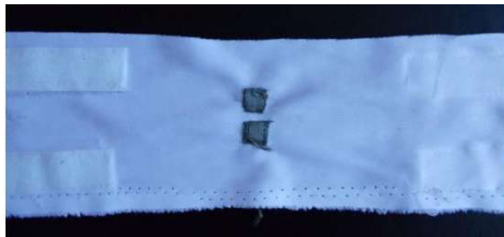
Figura 9: Protótipo de eletrodo feito de tecido condutivo.
