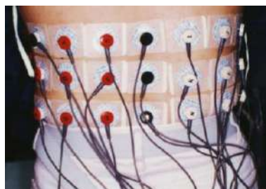
Figura 8: Arranjo de eletrodos monopolares sobre a região lombar. Matriz 7X3 (modificado de HU et al. , 2004, 2007, e 2010).
