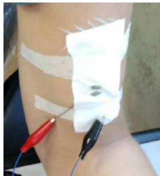
Figura 10: Protótipo de eletrodo feito com linha condutiva.
