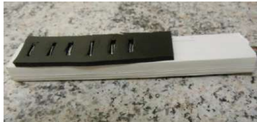
Figura 4: Vetor com seis eletrodos de fio de prata.
