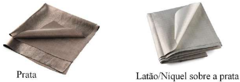
Figura 6: Tecido condutivo utilizado para a construção de eletrodos
