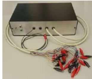
Figura 1: Primeiro protótipo do equipamento de EMG de 32 canais utilizado para a Tese.
