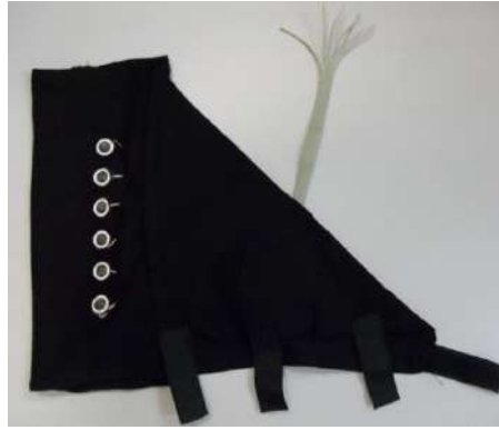
Figura 13: Protótipo de eletrodo de tecido condutivo preso com ilhós e conexão com fio encapado.
