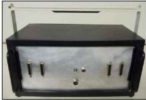
Figura 3: Segundo protótipo do equipamento de EMG com placa de aquisição de 32 canais.
