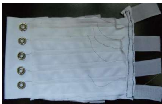
Figura 12: Protótipo de eletrodo de tecido condutivo preso com ilhós e conexão com fio envernizado.
