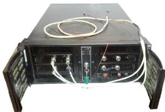
Figura 25: Sistema de captação de sinais com 32 canais.
