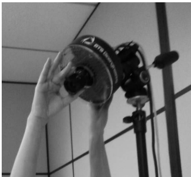
Figura 9: Regulação do foco e abertura da câmera.
