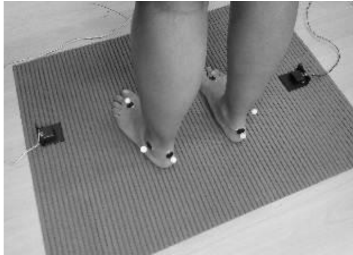
Figura 15: Plataforma de salto. Nos pés, os marcadores reflexivos do sistema de cinemetria, utilizados para comparação entre os dados de tempo de deslocamento vertical dos dois sistemas.
