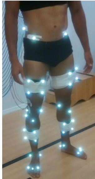
Figura 4.9: Posicionamento dos marcadores para o registro dos saltos.
