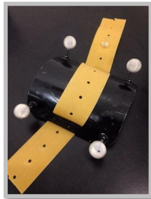
Figura 4.10: Cluster com quatro marcadores utilizado para a coleta de dados.
