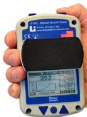
Figura 5.5: Dinamômetro de mão utilizado para os testes de força isométrica máxima.
