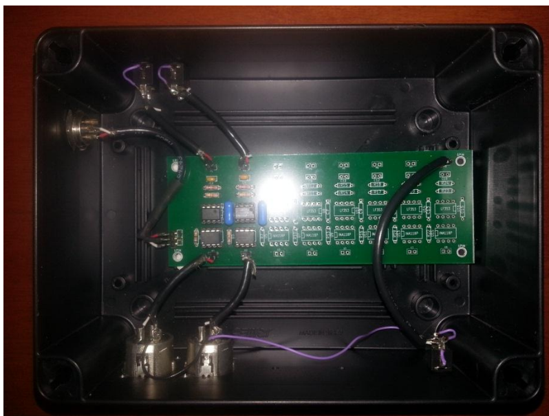
Figura 4.5: Amplificador de sinais desenvolvido para aquisição da SEMG.
