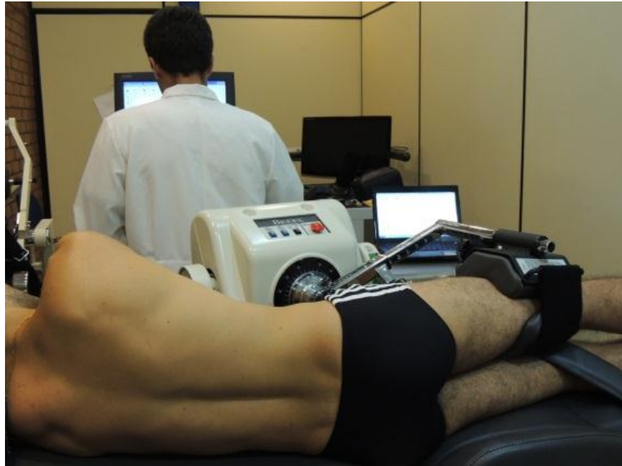
Figura 17 – Alinhamento do eixo equipamento / voluntário e fixação perna contralateral.
