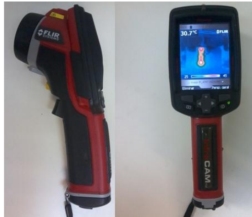
Figura 3: Câmera infravermelha vista em perfil (esquerda) e após captura de imagem térmica do phantom (direita).
