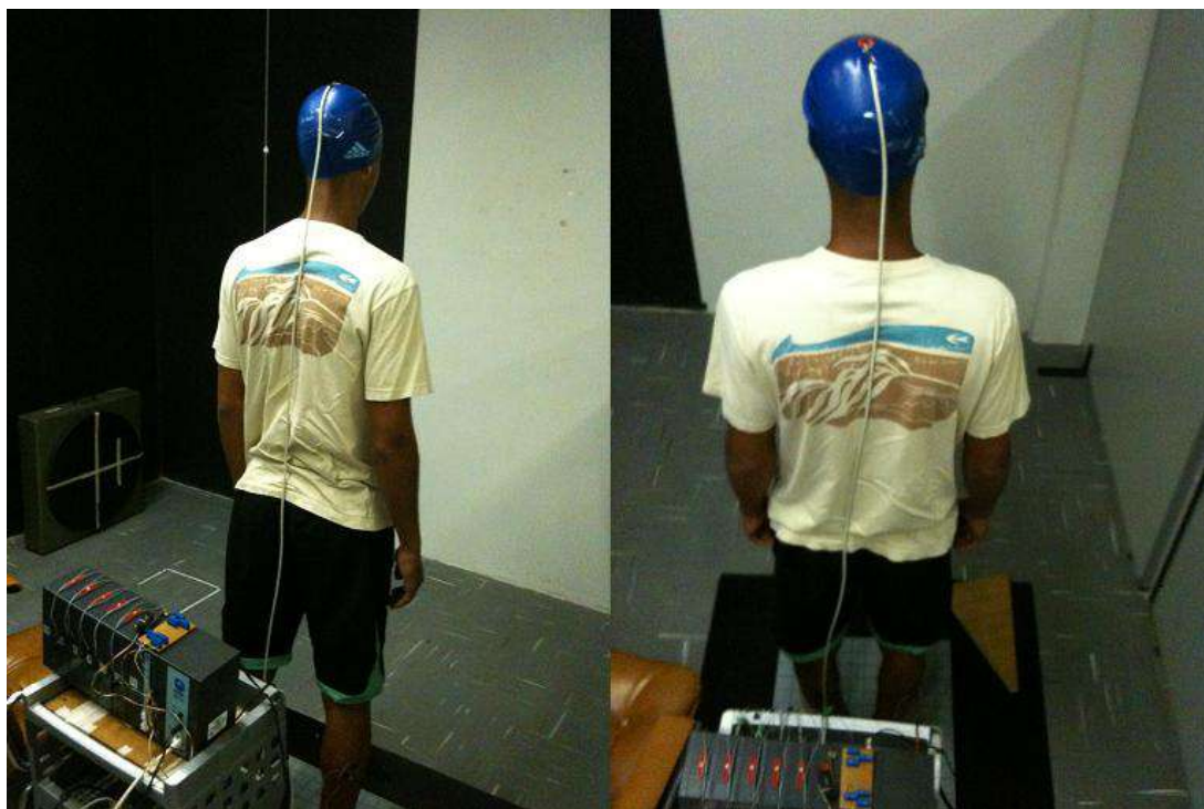
Figura 3.1 – Teste estabilométrico com a fixação do acelerômetro na cabeça
