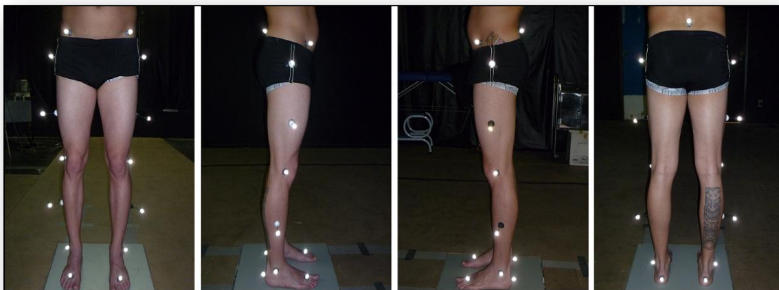
Figura 4.1: Posicionamento dos dezessete marcadores utilizados na coleta de dados para determinar os segmentos corporais dos membros inferiores.
