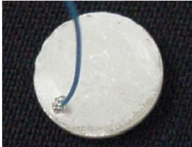
Figura IV.2: Fio soldado na face de polarização positiva da cerâmica.
