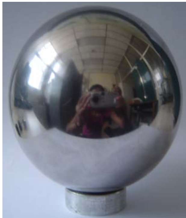
Figura IV.6: Molde esférico de aço sobre anel de alumínio com resina.
