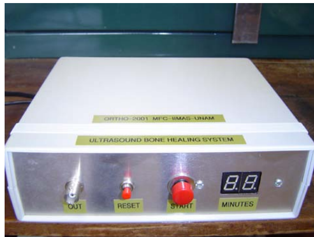
Figura IV.10: Gerador de excitação elétrica programado para pseudoartrose construído no IIMAS (México).
