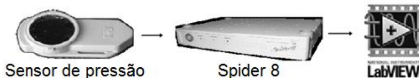
Figura 4.19: Diagrama de blocos do sistema de monitorização de pressão.
