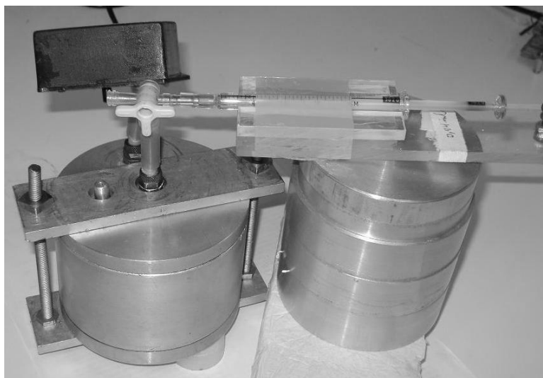
Figura 3.12. Montagem utilizada para caracterização do modelo de complacência do sistema respiratório do camundongo saudável.
