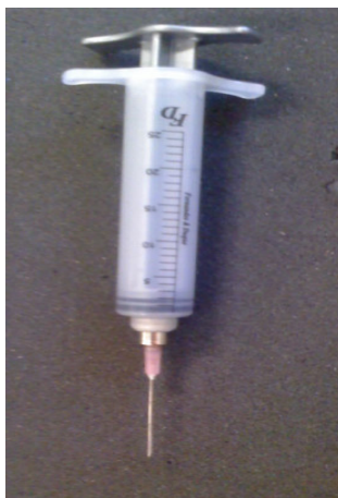
Figura IV.12: Seringa com capacidade para 25 ml utilizada para dimensionar as câmaras de ar da Célula Viscoelástica. A introdução do líquido na câmara é feita por meio da agulha que é posicionada no interior do compartimento (câmara inferior ou superior).
