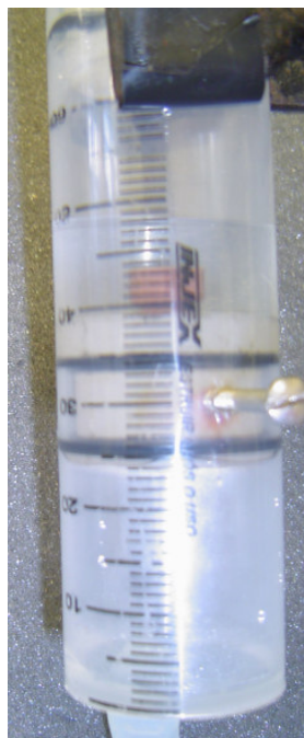
Figura IV.14: Foto da Célula Viscoelástica: Observa-se a demarcação na parede desta onde é representado o volume, em mililitros, em escala de 1 em 1 ml, até o máximo de 60 mililitros.
