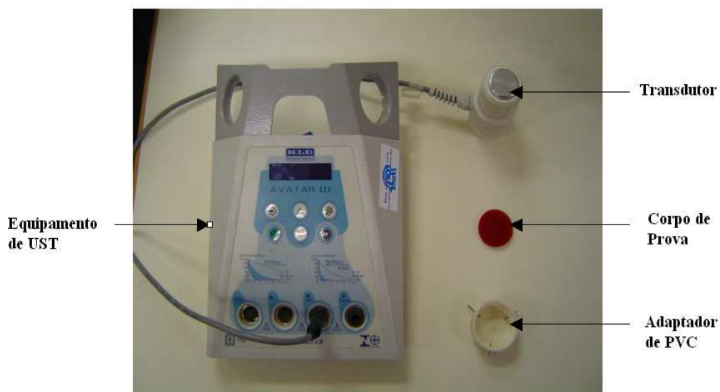
Figura IV.16 – Equipamento de US com seu transdutor, adaptador e corpo de prova do tipo disco utilizado para a obtenção da imagem térmica.
