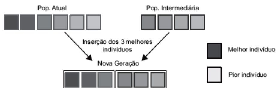
Figura 3.4: Esquema de re-inserção elitista combinada com a re-inserção baseada na aptidão.
