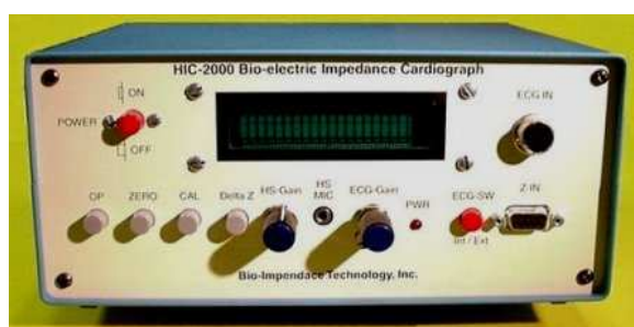
Figura 37. Monitor HIC-2000 ( Bio-Impedance Technology, Inc. , USA) para determinação da impedância cardiográfica. (Disponível em < http://www.microtronics.com >Acesso em 12 mar. 2008).
