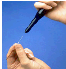
Figura 2. Uso da pipeta e do capilar do equipamento Yellow spring (Disponível em < http://www.yasilifesciences.com > Acesso em 12 mar. 2008).
