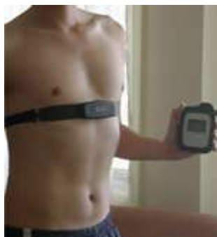
Figura 44. Detector de hipoglicemia Hypomon™, usando bioimpedância (Disponível em < http://www.aimedics.com > Acesso em 12 mar. 2008).
