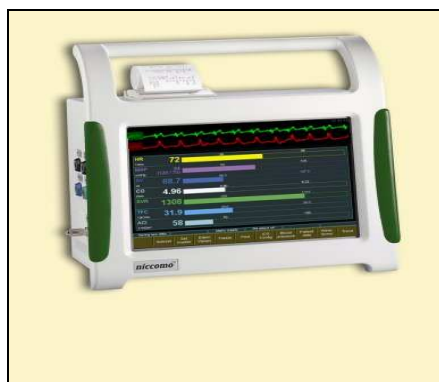
Figura 36. Monitor Niccomo ™ (Medis, Alemanha) para determinação não-invasiva da hemodinâmica. (Disponível em < http://www.niccomo.com >Acesso em 12 mar. 2008).
