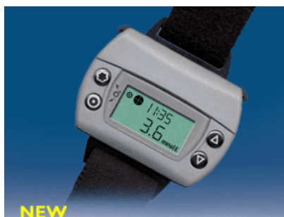
Figura 41. Medidor de glicose não-invasivo GlucoWatch Biographer (Disponível em < http://www.glucoath.com > Acesso em 12 mar. 2008)).
