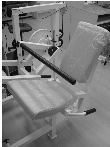
Figura IV.5 – Parte do sistema mecânico destinada ao movimento de flexão e extensão de cotovelo.
