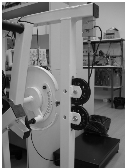
Figura IV.2 – Célula de carga e sua fixação utilizada para a mensuração do sinal de força nos movimentos de flexão e extensão do cotovelo.
