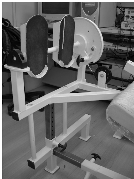
Figura IV.6 – Parte do sistema mecânico destinada ao apoio dos membros inferiores nos movimentos de flexão plantar e dorsiflexão.
