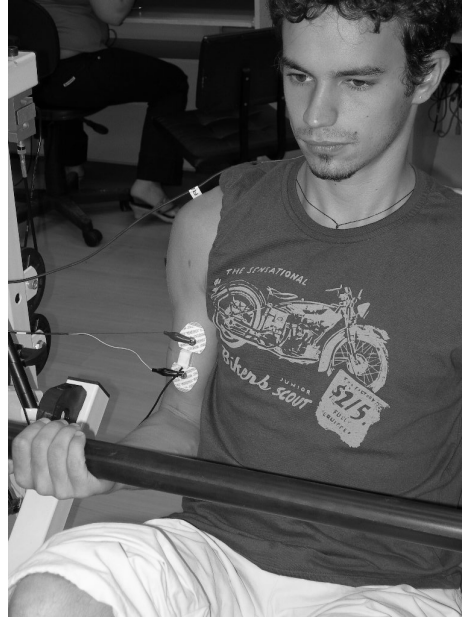
Figura III.8 – Local de colocação dos eletrodos e acelerômetros nos músculos bíceps braquial, com base no protocolo para colocação de eletrodos de EMG proposto por HERMENS et al. (1999).
