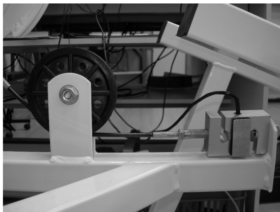
Figura IV.1 – Célula de carga e sua fixação utilizada para a mensuração do sinal de força nos movimentos de flexão plantar e dorsiflexão
