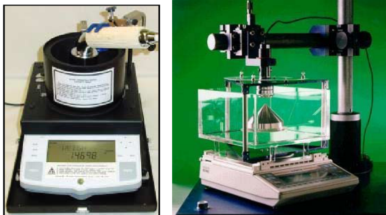
Figura 4.2 – Balanças de radiação, na figura da direita pode-se observar o transdutor, a balança o suporte e o alinhamento entre o transdutor e o alvo cônico, na figura da esquerda pode-se observar um outro projeto no qual as paredes do tanque estão revestidas para evitar a re-irradiação.
