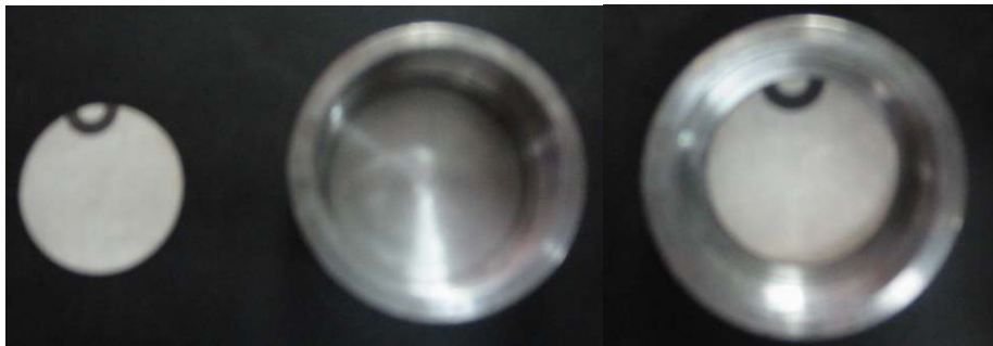
Figura 5.1 - Foto detalhada do Transdutor mono-elemento apresentando a cerâmica, o copo e a cerâmica montada dentro do copo.
