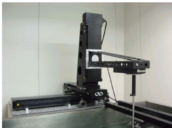
Figura 6.4 – Detalhe do sistema de posicionamento onde pode-se observar o suporte da haste que movimenta o hidrofone segundo os eixos X, Y e Z (INMETRO).
