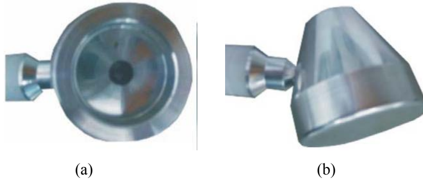
Figura 5.4 – (a) Corpo do Manípulo sem o copo; (b) Transdutor montado com as cerâmicas
