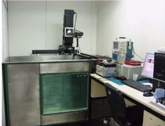
Figura 6.3 – Tanque acústico de aço inoxidável e com uma janela de vidro do LABUS de dimensões 1,7 m x 1,0 m x 0,8 m (retirado de Alvarenga et al. , 2007).
