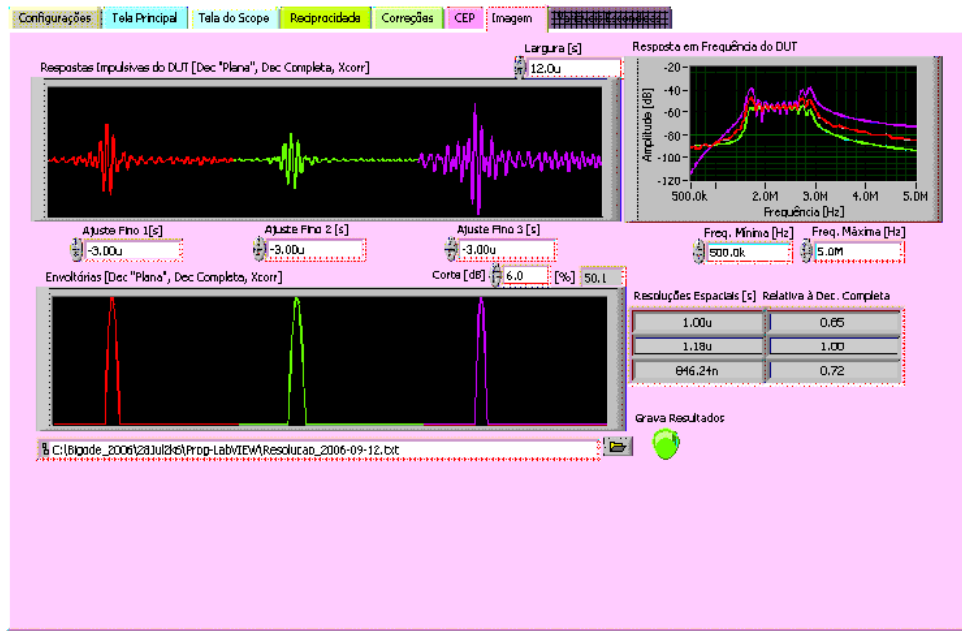
Figura A5 – Painel frontal relativo aos sinais decodificados e às envoltórias exibindo um sinal de eco decodificado segundo três técnicas de decodificação, acima: a esquerda a deconvolução plana, uma técnica ainda experimental, no meio a deconvolução completa e à direita correlação cruzada abaixo as envoltórias dos respectivos sinais decodificados. No na caixa acima a direita são exibidos os espectros dos sinais. Para este sinal foi utilizada uma excitação compensada.
