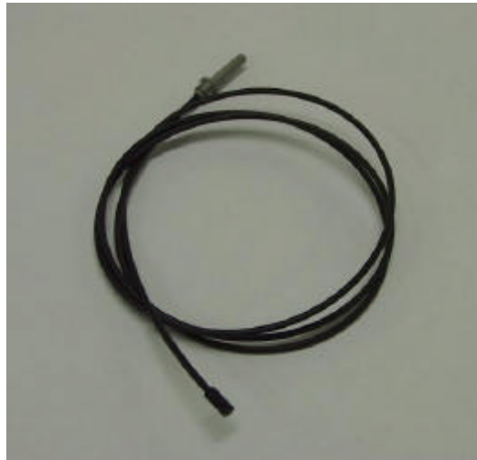
Figura 4.27: Sonda sensora após a fixação do conector simplex .
