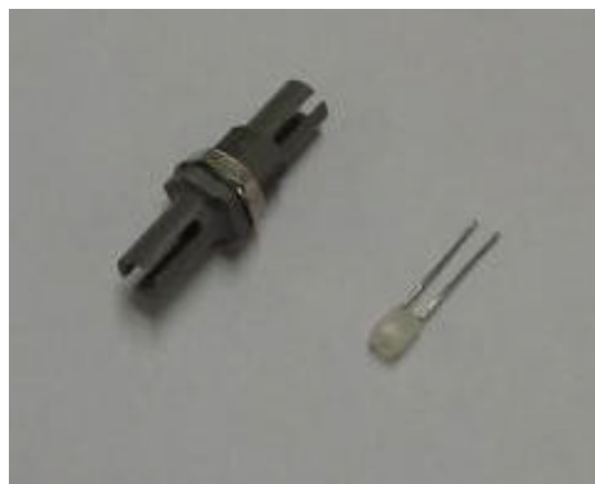
Figura 4.28: LED polido COTCO e conector para emenda mecânica.
