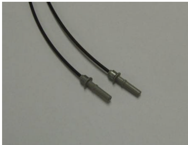
Figura 4.24: Conector simplex com a POF após o polimento.
