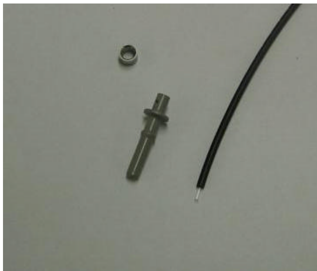
Figura 4.22: Conector simplex e POF. Fixação da POF no conector simplex .
