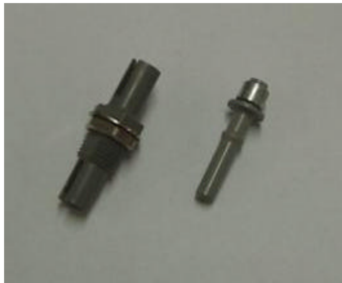
Figura 3.4: Emenda mecânica e conector simplex utilizado em POF.
