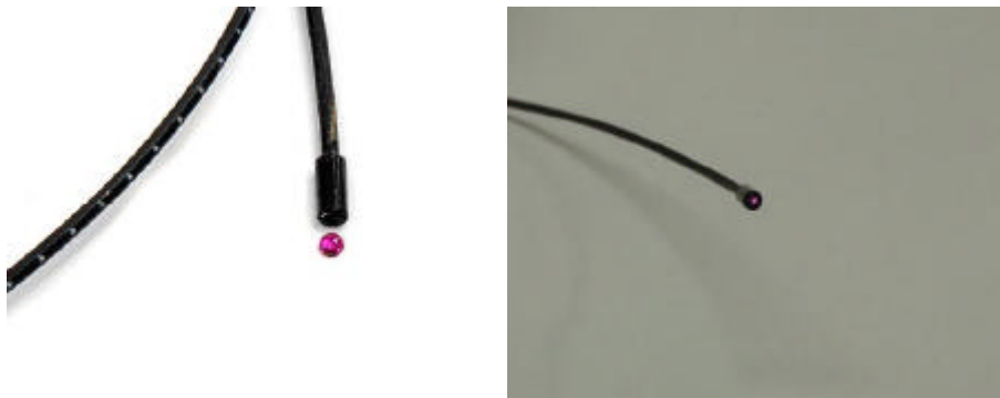
Figura 4.26: Ponta da sonda sensora de temperatura montada com um cristal de rubi semi-esférico com 1mm de diâmetro e um conector para POF.
