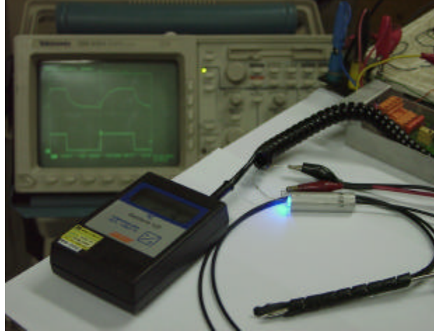
Figura 4.17: Sensor óptico fixado a uma ponta sensora de temperatura do termômetro SalvTerm 120.
