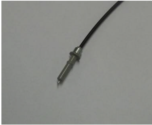
Figura 4.23: Fixação da POF no conector simplex .
