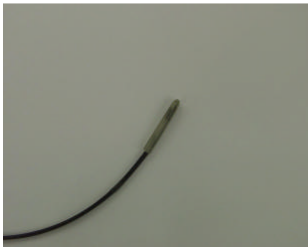
Figura 4.12: Sensor óptico revestido com resina acrílica de polimetilmetacrilato.
