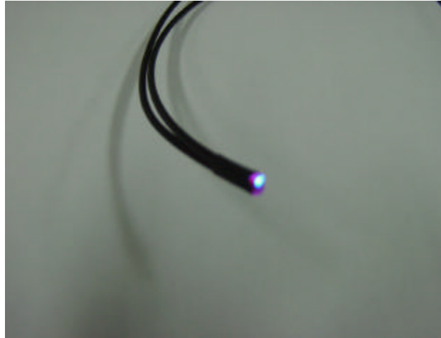
Figura 4.11: Cristal de rubi bombeado opticamente com um comprimento de onda de 465 nm.
