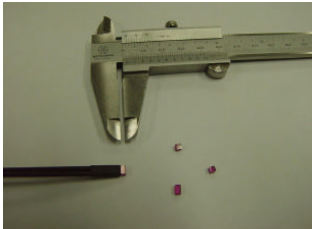
Figura 4.9: Montagem do sensor de temperatura utilizando duas fibras ópticas plásticas e um cristal de rubi sintético.
