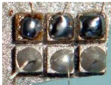
Figura V.5 – Fixação das conexões elétricas não aproveitadas. Acima. Três conexões, com um procedimento específico, com solda chumbo-estanho. Abaixo. Três conexões com cola Epóxi condutora. Elementos com um milímetro de lado.
