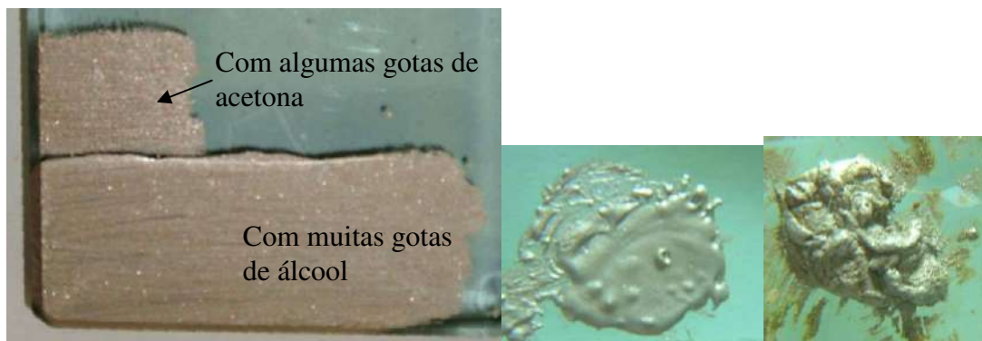
Figura IV.22 – Esquerda. Cola depositada com pincel, diluída em álcool e em acetona. Com muito diluente a condutibilidade diminui ainda para valores aceitáveis, além de curar e endurecer. Centro. Cola diluída com uma marca de álcool. A superfície encontra-se mais regular e suave. Direita. Cola diluída com outra marca de álcool. A superfície encontra-se irregular. Estas colas apresentavam prazos de validade vencidos há cerca de um ano.
