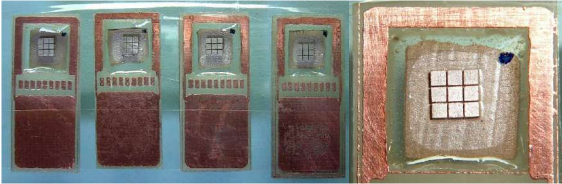
Figura IV.32 – Visão geral de quatro matrizes fixadas nas respectivas bases de encapsulamento (à esquerda). Na foto da direita encontram-se detalhes, como a cola Epóxi unindo a matriz na base de encapsulamento.
