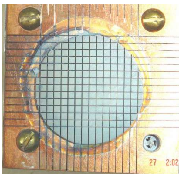
Figura A.7 – Fotografia do disco de cerâmica cortado após o processo de calibração e ajuste da máquina de corte Logitech, modelo 15 SAW. Cada quadrado cerâmico apresenta 1,0 mm de lado e o corte 0,15 mm de espessura.
