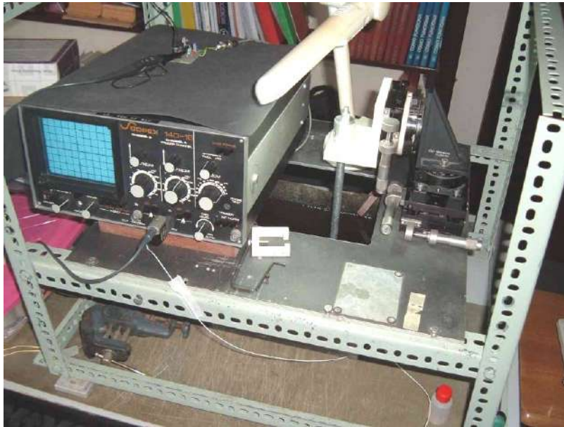
Figura V.12 – Fotografia da montagem da realização das medições do campo acústico. O amplificador sintonizado está encima do osciloscópio. O posicionador XYZ encontra-se à direita. O tanque encontra-se entre os dois últimos
