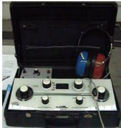
Figura 7 – Audiômetro Dicton CAT-42 com o fone de ouvido TDH 39
